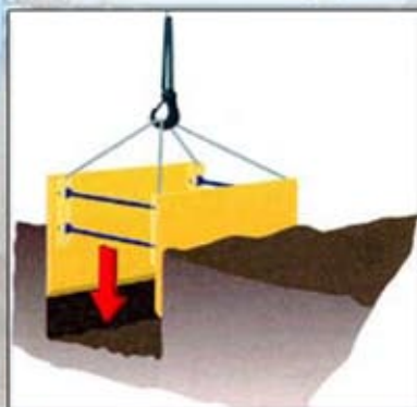
Mise en place des panneaux de blindage dans la tranchée ...
