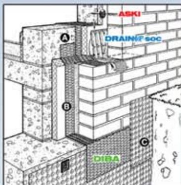
DIBA est une bande de polyéthylène noire, munie sur les deux faces d'une texture nervurée. DIBA atteint une épaisseur totale d'environ 1 mm. Des nervures en forme de losange (40 x 10 mm) et des nervures longitudinales forment une arête et préviennent un mouvement latéral de la maçonnerie. Longueur des rouleaux : 50 cm
